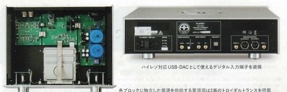
各フ 0.7 3 電源部は2基のトロイダルトランスを搭載
